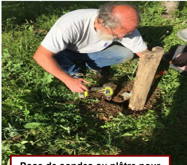
Pose de sondes au plâtre pour la mesure de l'humidité du sol
