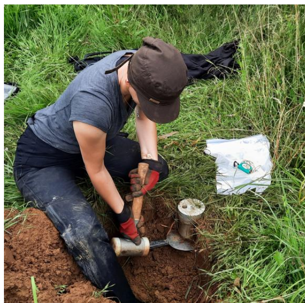
Figure 70 : Prélèvement des échantillons de sol pour mesure de la densité apparente, avec la méthode des cylindres à Cademène le 8 juillet 2021
